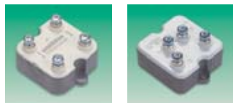
A: H=24, W=45, D=45 B: H=30, W=71, D=60 I 0 = 30A dc @ T c = 94°C I FSM = 370A @ T vj = 25°C
